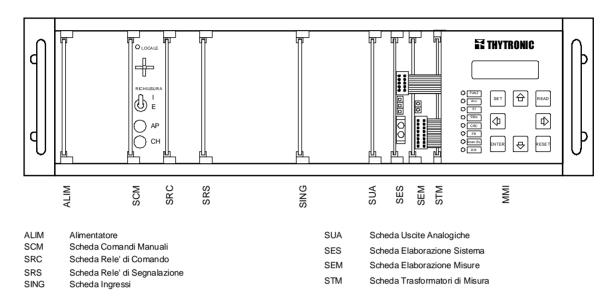
Figura 2 Vista frontale del pannello DMC905 (DV905A2)
