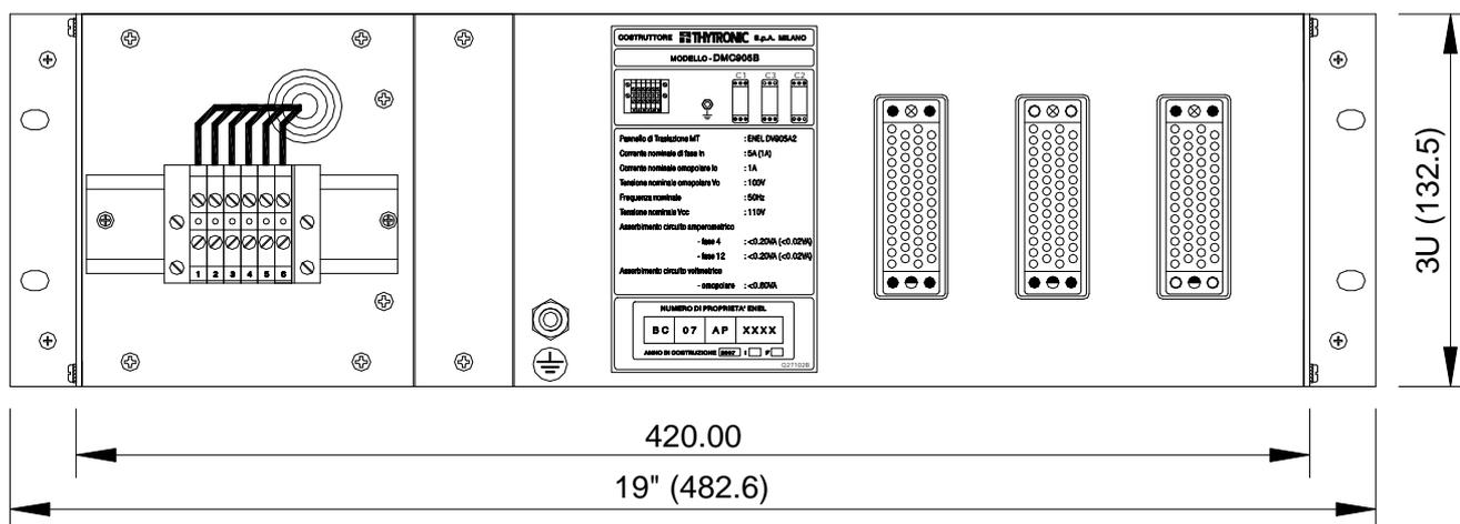
Vista posteriore del pannello DMC905B (DV905A2)
