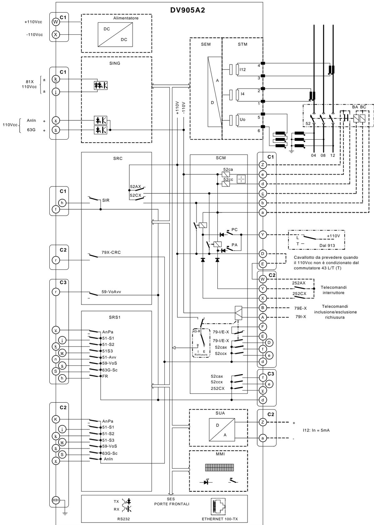
Schema di inserzione del pannello DMC905B (DV905A2)
