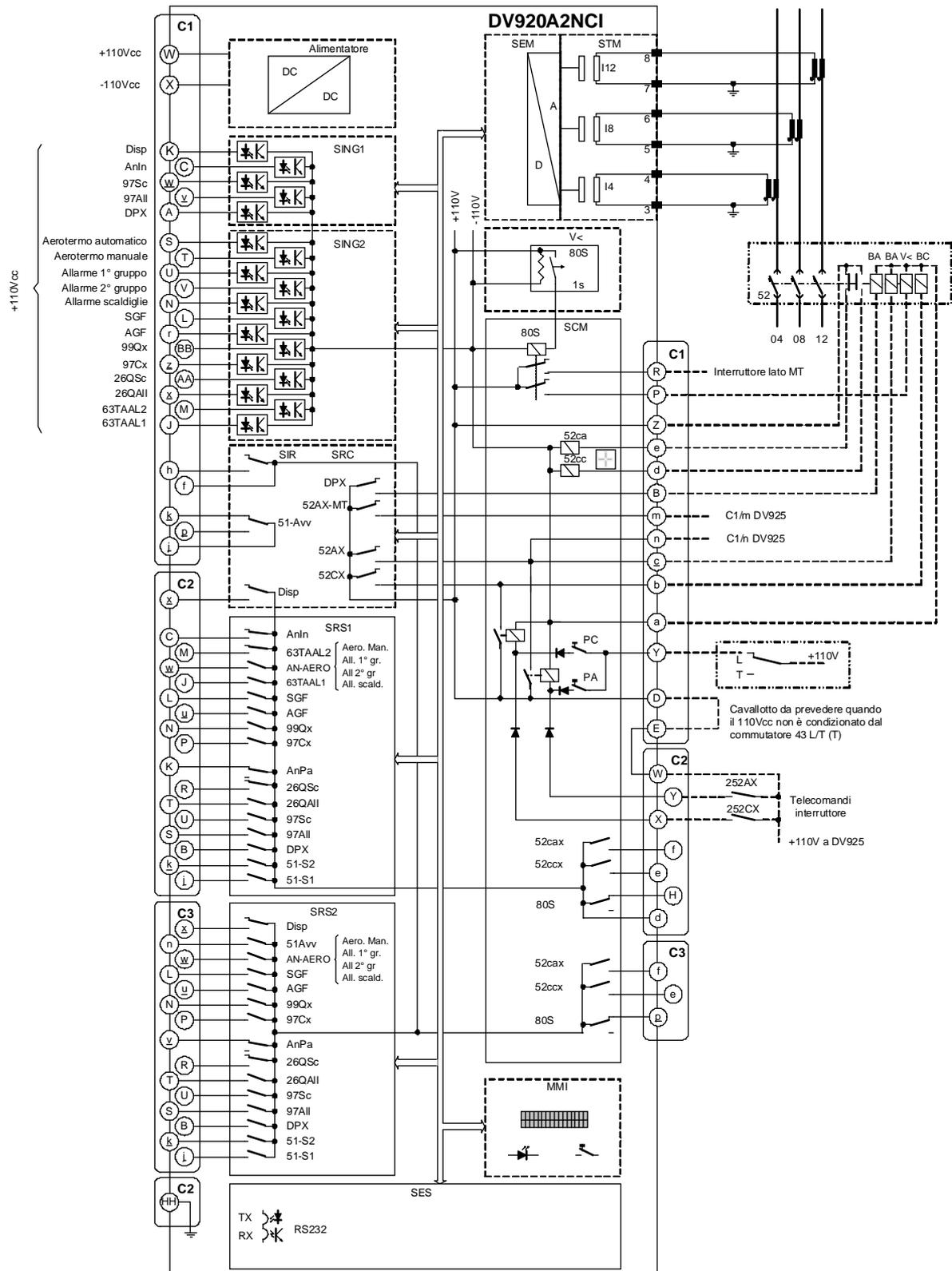
Figura 1 Schema di inserzione del pannello DMC901 (DV901A2NCI)
