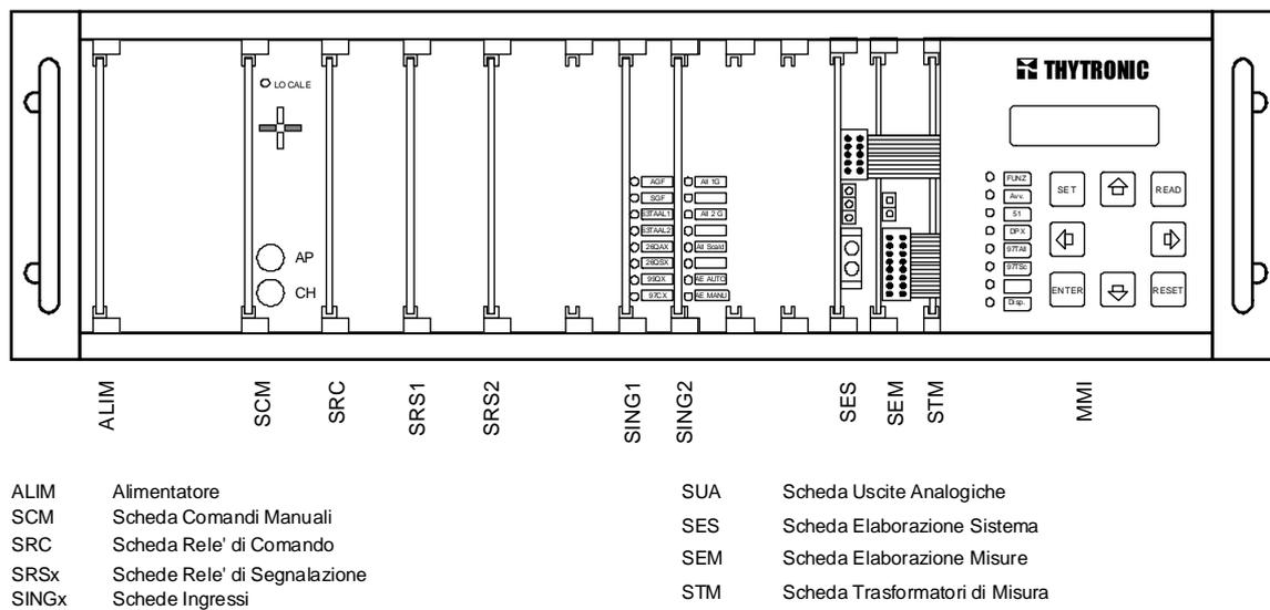
Figura 2 Vista frontale del pannello DMC920 (DV920A2NCI)
