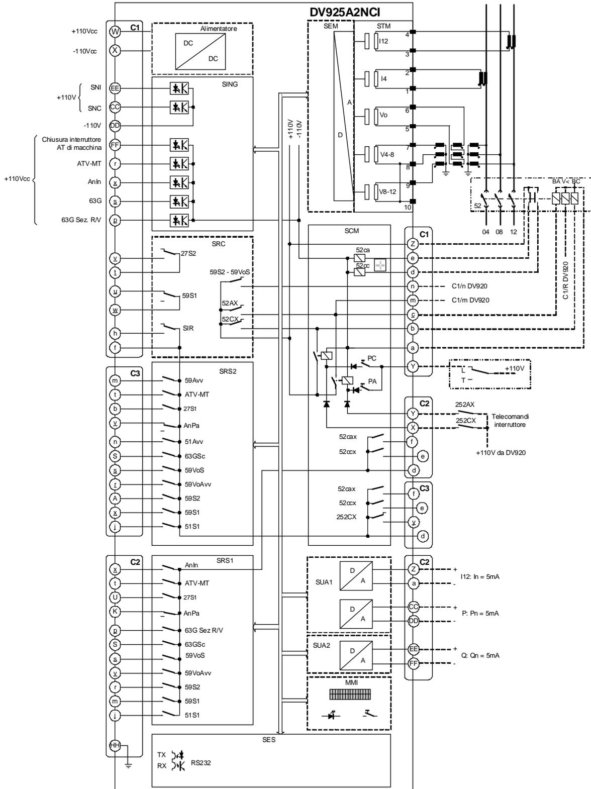
Figura 1 Schema di inserzione del pannello DMC925 (DV925A2NCI)
