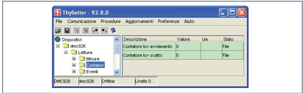
Ogni contatore si azzerava automaticamente quando raggiunge 10000 conteggi. E' possibile azzerare manualmente tutti i contatori mediante unico comando ThySetter (**Reset** **Reset Contatori**).
