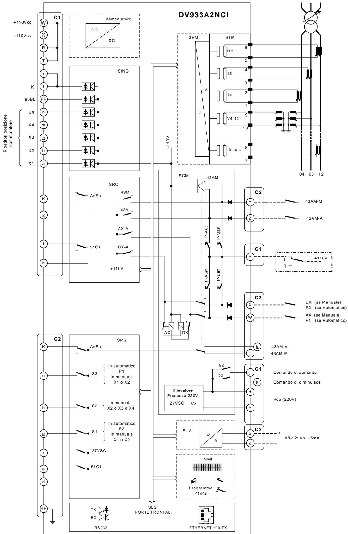
Schema di inserzione del pannello DMC933B (DV933A2NCI)
