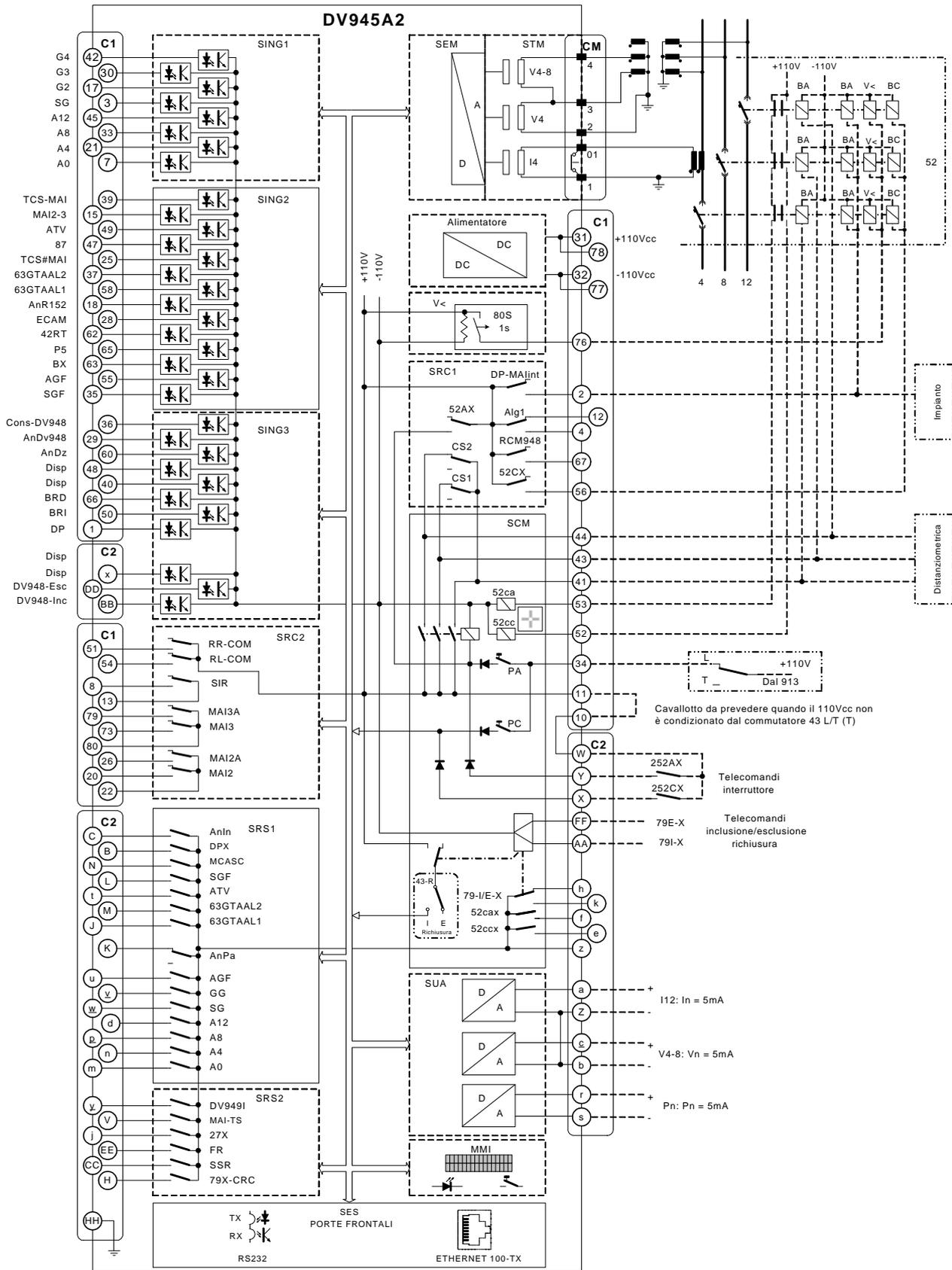
Schema di inserzione del pannello DMC945B (DV945A2)
