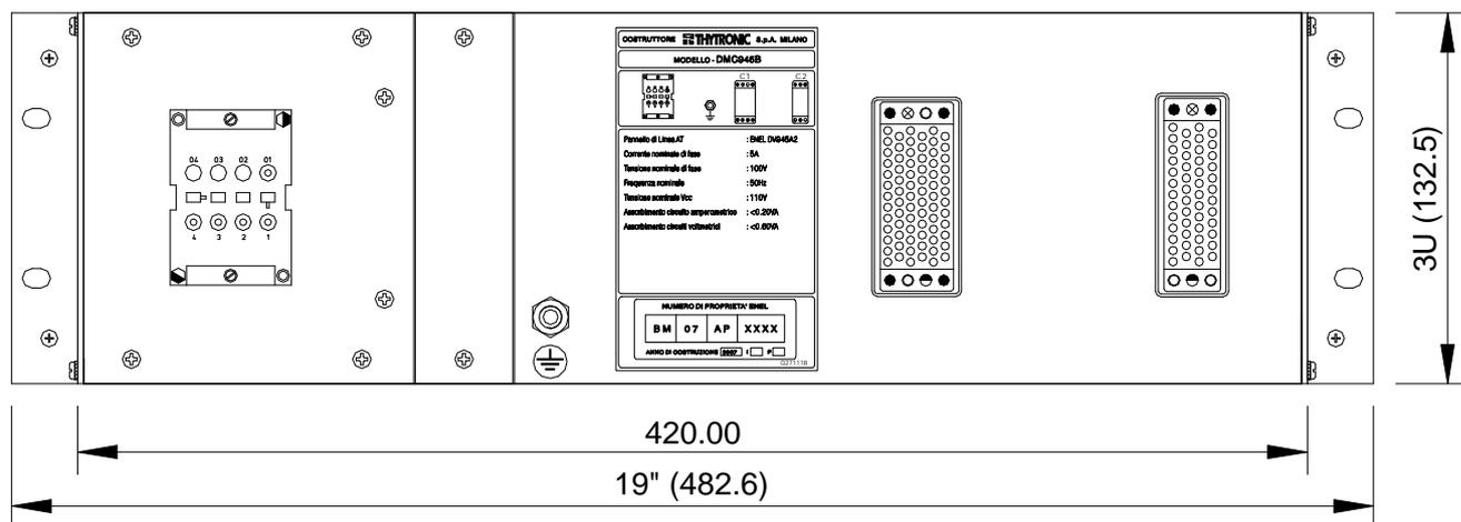
Vista posteriore del pannello DMC945B (DV945A2)
