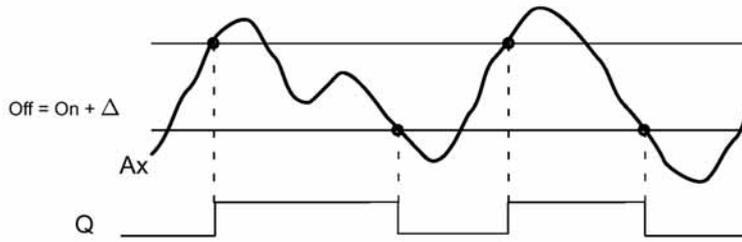
时序图B：偏差 为正值时的时序图
