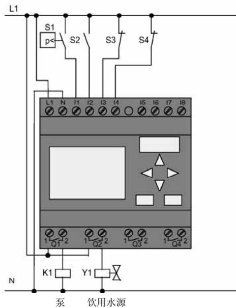
除 LOGO! 以外，只需要用压力开关和浮子开关来控制泵。如使用三相电机，则需要一个主接触器以开关水泵。使用单相交流泵时，如交流电机所需的电流大于输出继电器Q1能提供的电流，则需增加一个接触器。螺线管阀的功耗通常足够小，因此能直接由输出Q1控制。
