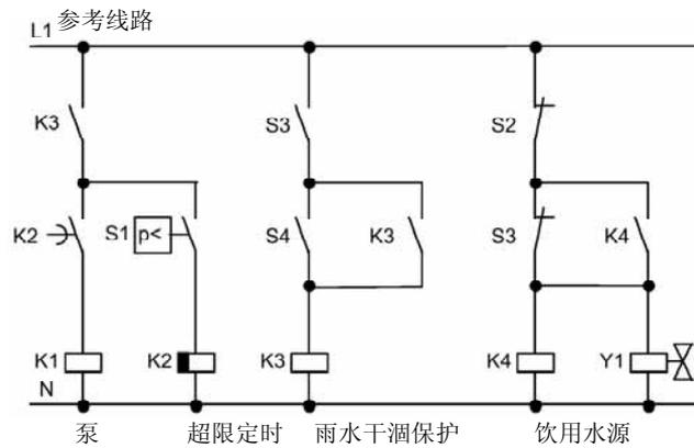
泵和螺线管阀由一个压力开关和三个在雨水容器中的浮子（水位）开关控制。当压力降低到最低允许值时，泵必须接通。达到运行压力时，经过几秒钟的短超限时间后再次断开。如较长时间用水，引入超限定时可避免泵经常的接通和断开。
