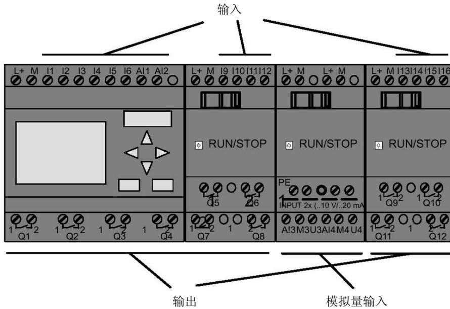
每个输入由带数字编号的字母 I 标识。从正面看 LOGO! 时，可以看到输入端子在 LOGO! 的顶部。只有模拟量模块 LOGO! AM 2 和 AM 2 PT100 的输入端子在 LOGO! 的底部，每个输出由带数字编号的字母 Q 标识，在上图中，可以看到输出端子在 LOGO! 的底部。
