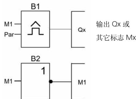
2. 如下页所示组态阈值触发器，由于该反向的标志在每次程序循环生成一个脉冲。触发器的时间间隔设定为 2 秒。
