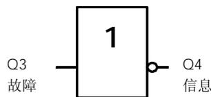
系统运行时，输出端 Q4 的触点是常闭的。除非电源故障或系统故障，继电器 Q4 的触点是不会释放的。例如，该触点可用作远程故障指示。
