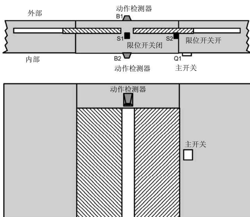
门通常由具有安全离合器的电机驱动，这样可避免将人挤压而受伤。控制系统通过主开关连接到主电源。
