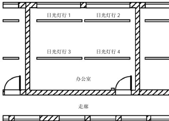
规划公司照明系统时，使用的灯的类型和数量取决于所需的照明亮度。为了有效使用经费，日光灯经常排列成一行。根据房间的不同要求，将日光灯再细分成若干开关线路。
