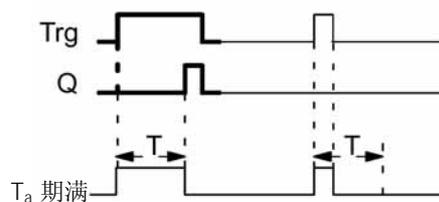
时序图中的加粗部分也是接通延时功能块的符号。
