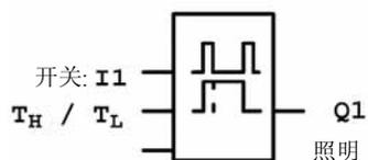
当输入 I1 有一个脉冲信号时，输出 Q1 接通并延续预置时间  $T_H$  后断开。
