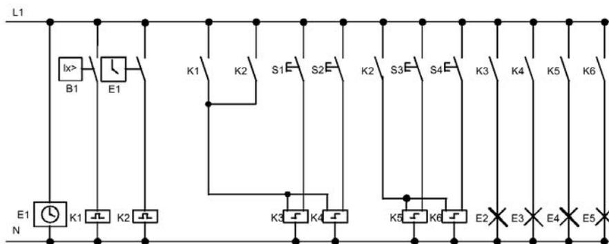
通过门旁的按钮控制脉冲继电器以控制照明灯。与此独立的是，通过定时器使脉冲继电器复位，也可以通过亮度敏感开关（经集中断开的输入点）复位脉冲继电器。通过脉冲继电器可缩短断开命令的脉冲宽度，这样在照明灯断开后仍有可能就地操作灯的开和关。
