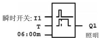
输入端 I1 有脉冲信号时，输出端 Q1 接通并保持 6 分钟后断开。
