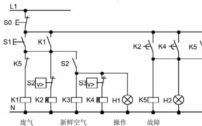
通风系统由流量监视器控制。如室内没有空气流通，则等待一个短暂时间，将系统断开并报告故障，作为响应，用户应按下OFF（断开）开关。
