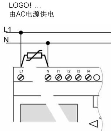
为了抑制浪涌电压, 需安装
