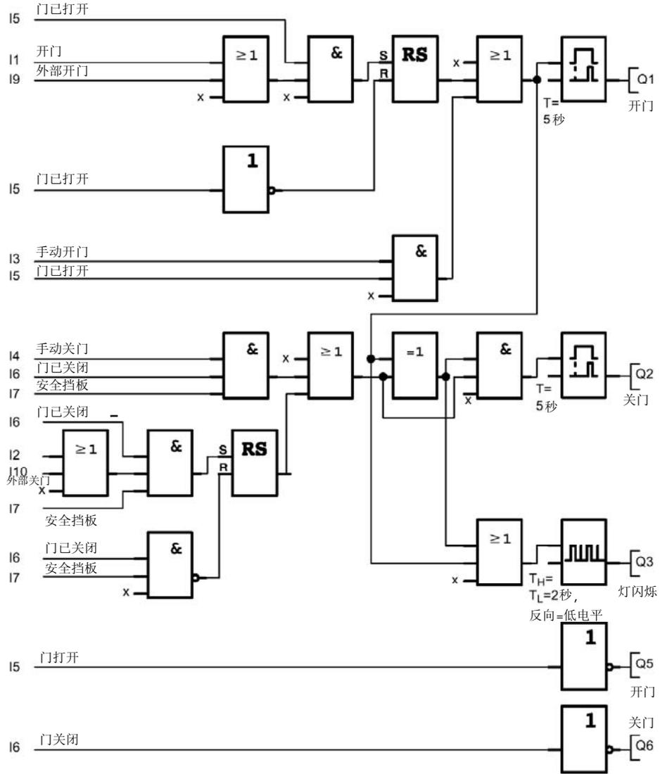
开门和关门启动按钮控制门的移动和避免门向与当前移动方向相反的方向移动。当按钮门到达有关的限位开关时，门停止移动。通过安全挡板可中止门的移动以避免关门时卡住人和物。
