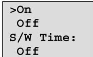
S/W Time转换的当前设置在最下面的行显示。默认的设置是“Off”，即取消S/W Time的转换。
