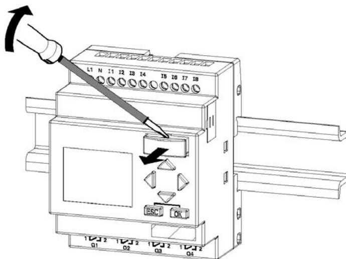
小心地将一个螺丝刀插入程序模块（卡）上端的凹槽中，平稳地程序模块（卡）撬离少许，然后拆下程序模块（卡）。
