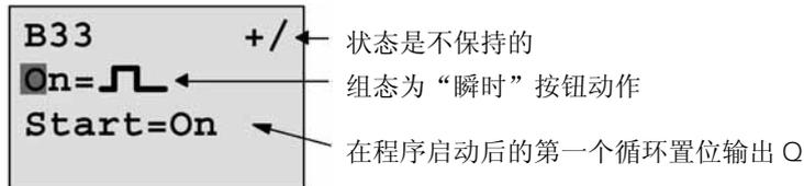
将“Par”切换到“Switch”并在程序启动后进行初始化。
