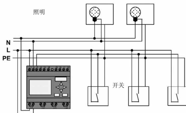
应用 LOGO! 的照明系统的外部接线和常规的楼梯和走廊的照明系统的接线相同。所不同的是替换了脉冲继电器或自动楼梯照明装置。增加的功能可直接输入到 LOGO!。
