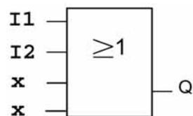
在此图中，输入 I1 和 I2 连接到“或”功能块。剩下的最后二个输入没有使用，故标识为“x”。
