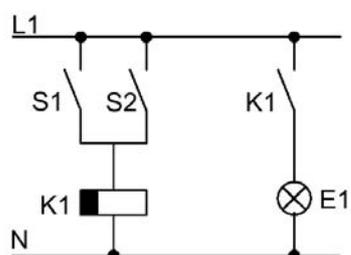
您已了解该线路的第一部分。S1 或 S2 开关控制一个继电器。该继电器用于接通负载 E1 并在延时 12 分钟后断开负载 E1。
