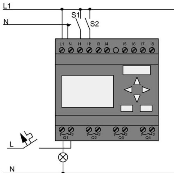
开关S1 作用于输入I1，而开关S2 作用于输入I2。负载则连接到继电器Q1。
