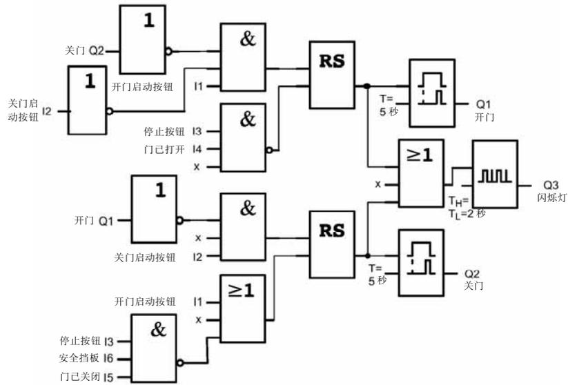
开门或关门按钮控制门的移动和避免门向与当前移动方向相反的方向移动。当按下停止按钮或门到达有关的限位开关时，门停止移动。通过安全挡板可中断关门动作以避免关门时卡住人和物。
