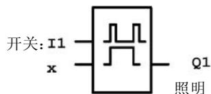
输入端 I1 有脉冲信号时，输出 Q1 接通或断开。
