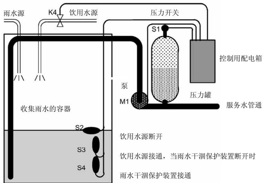
雨水收集在容器中，然后从该容器经由泵站泵入服务用水水管道系统，可以如饮用水那样从管道应用雨水。如该容器中的雨水干涸，该系统能提供饮用水。
