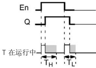
时序图中的加粗部分也是随机发生器功能块的符号。
