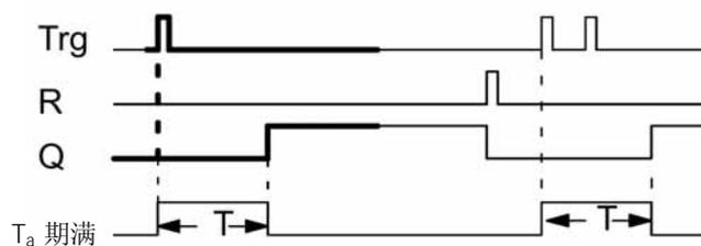
时序图中的加粗部分亦是有保持接通延时功能块的符号。
