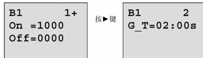
3. 现在启动线路程序和切换LOGO! 到参数赋值模式，在参数赋值模式，观察触发器的参数。
